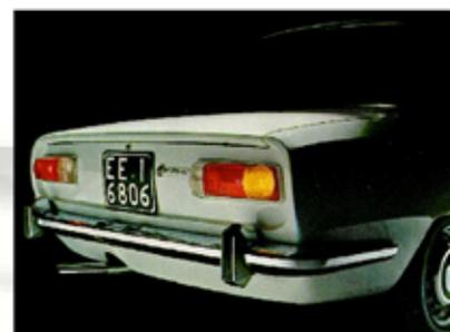
Poucos sabem que existiu uma 1750 Station Wagon: chamava-se Giardinetta Veloce e foi estudada e produzida em 69 pela Automil (Concessionário Milanês da Alfa) e pelo carroçador Pavesi também de Milão, mantendo as dimensões exteriores da Berlina (4,39m de comprimento; 1,56m de largura e 1,43 de altura), mas com suspensões reforçadas.
